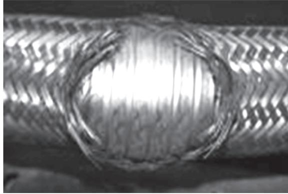
高圧ガス設備には金属フレキシブルホースが配管ラインの各所に使用されています。しかし外面がステンレス鋼のブレードで覆われて内管のフレキシブルチューブ（蛇腹管）は目視等による検査が難しい構造になっています。
